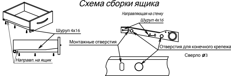
Схема сборки ящика
